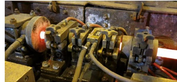
Zur Beurteilung der Drahtqualität erfolgt nach der Prüfung eine statistische Bewertung der Fehlerverteilung (Section Quality Index) sowie eine Bewertung des gesamten Coils (Rod Quality Index) für eine umfassende Prozessüberwachung. Zusätzlich findet eine Auswertung von gravierenden Einzelfehlern statt, die bei der statistischen Erfassung untergehen würden.
