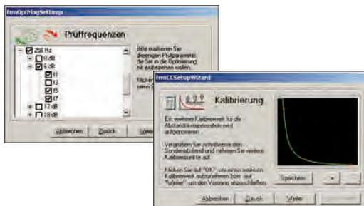
Auch der STATOGRAPH ECM CE verfügt über die Assistentenfunktionalität. Neben der dynamischen Ermittlung der besten Prüfeinstellungen kann auch die Abstandskompensation über eine Assistentenfunktion menügeführt optimiert werden
