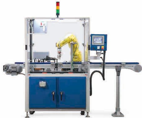
*Vollautomatisches mehrkanaliges Riss-Prüfsystem mit automatischer Beladung des Prüfteilepuffers*
