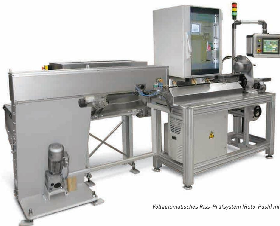
*Vollautomatisches Riss-Prüfsystem (Roto-Push) mit Stufenförderer*
